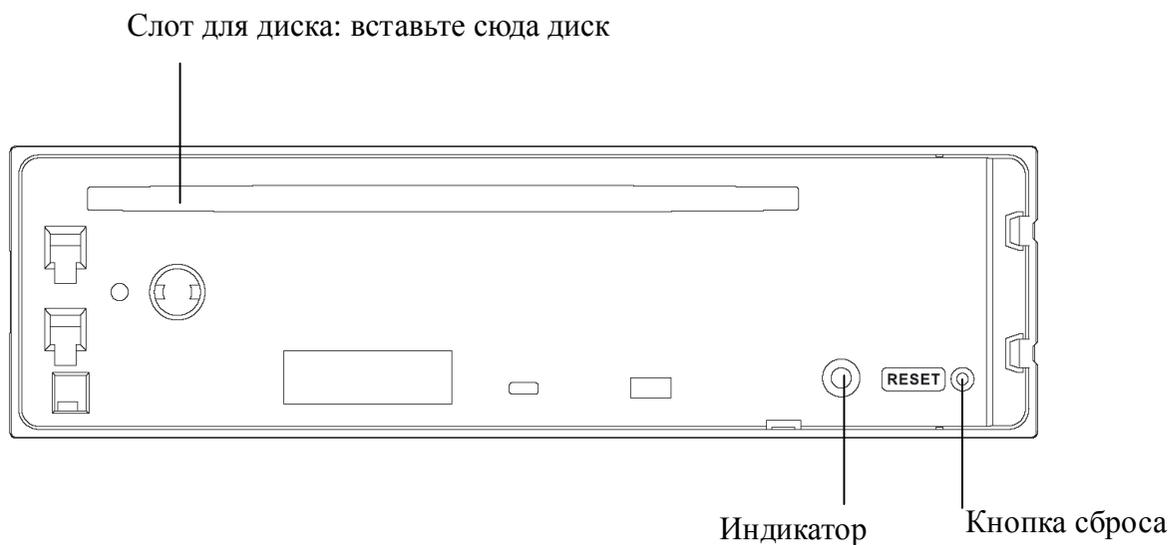
**Примечания:** При нажатии кнопки RESET настройки времени и сохраненные станции будут удалены из памяти устройства.
